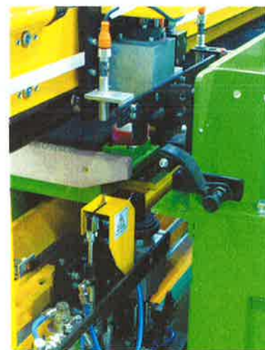
Double têtes de coupe de grande précision pour un respect parfait du contour par la coupe supérieure et inférieure et système de séparation à cutter pour une séparation nette et plus rapide du film.
