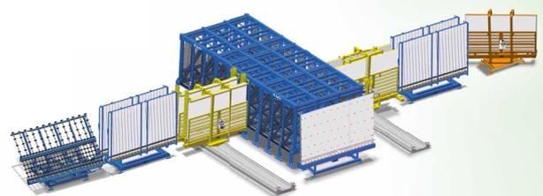
Le convoyeur de redressement ou le convoyeur pivotant dispose d'un panneau de transfert double, d'une navette d'insertion simple ou double. La SortJet est exactement adaptée aux exigences de production. Il automatise vos processus entre la découpe et la ligne ISO. Les plaques manquantes ou les dommages résultant de la manutention manuelle appartiennent désormais au passé.
