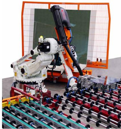
Des outils spéciaux permettent par exemple le prélèvement de verres à couche. Pour les différentes dimensions de verre, des cadres à ventouses de tailles différentes sont utilisés en alternance. Grâce à des procédures et des processus exactement définis, le risque de dommages est réduit à un minimum.
