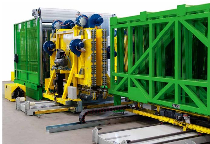
Les chariots à compartiments sont guidés soit automatiquement soit par un opérateur, par exemple vers la ligne ISO ou vers le façonnage du verre. Le prélèvement du verre est effectué avec un dispositif d'alimentation du verre dans un ordre séquentiel, autrement dit dans l'ordre des verres triés ou dans un ordre aléatoire. Une navette avance devant les chariots à compartiments disponibles afin d'accéder à tous les verres.
